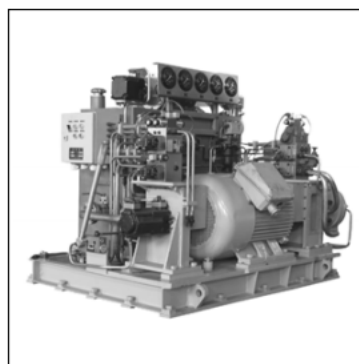
5、泵组旁置式布置：电机泵组安装在油箱旁边与油箱共同一个底座，其适用于降低泵站高度、较大功率的泵组，维护方便。
