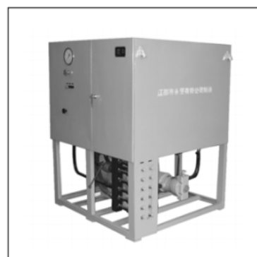
3、泵组下置式布置: 电机泵组位于油箱下面, 主要适用于野外作业的液压装置或改善泵的吸油能。
