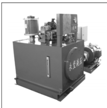
4、泵组旁置分离式布置：电机泵组独立底座，安装在油箱侧面，其适用于大功率的泵组，维护方便。
